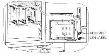
Fig. 16 — PIC6 Wiring
