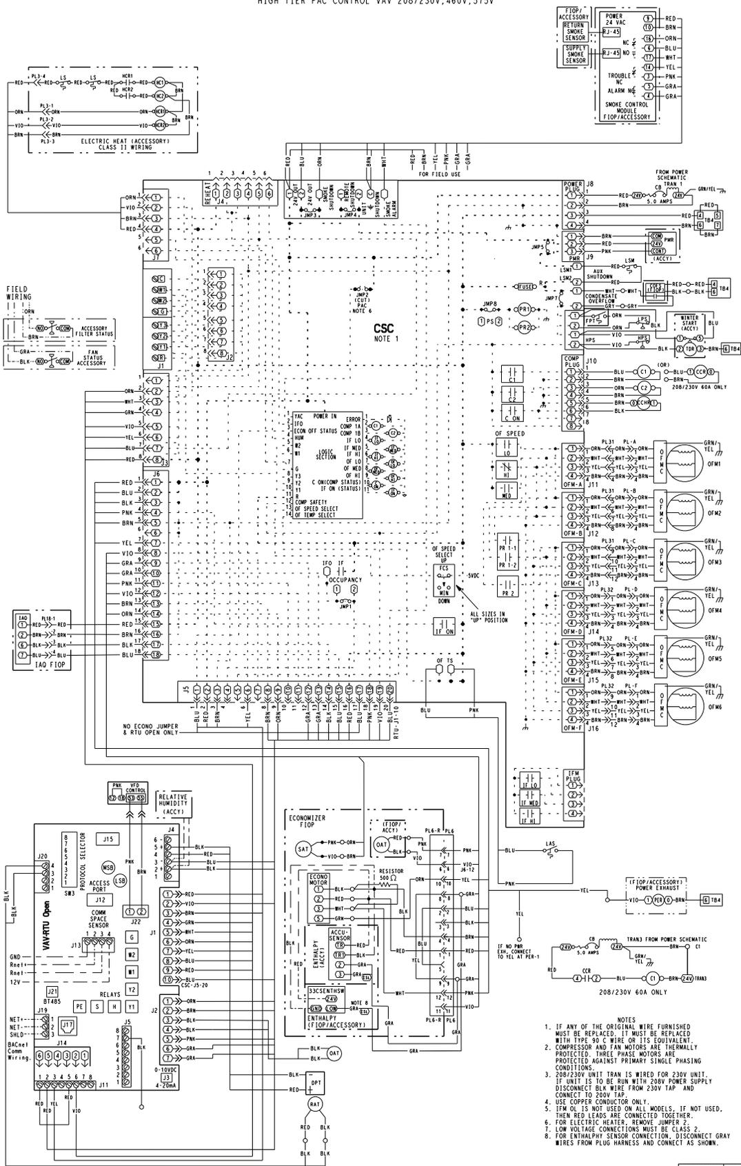
Fig. 43 — 50LC\*B 14-26 VAV-RTU Open Control Wiring Diagram
