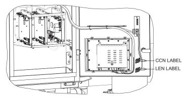
Fig. 16 — PIC6 Wiring
