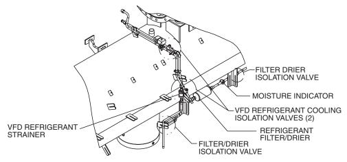
Fig. 54 — Refrigerant Filter/Drier
