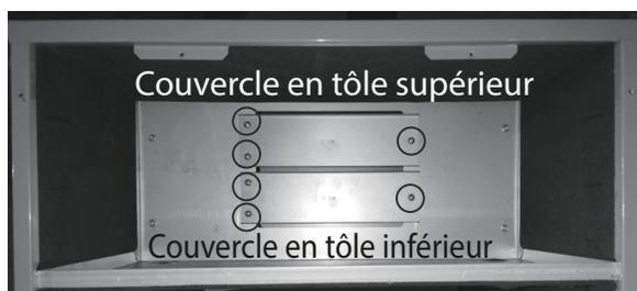
**Fig. 23 – Retirez les couvercles en tôle**
