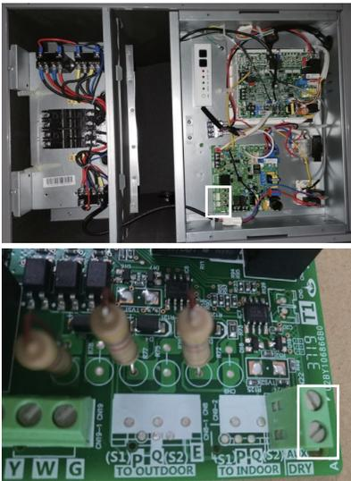
**Fig. 29 – Raccordez le fil du chauffage auxiliaire**
