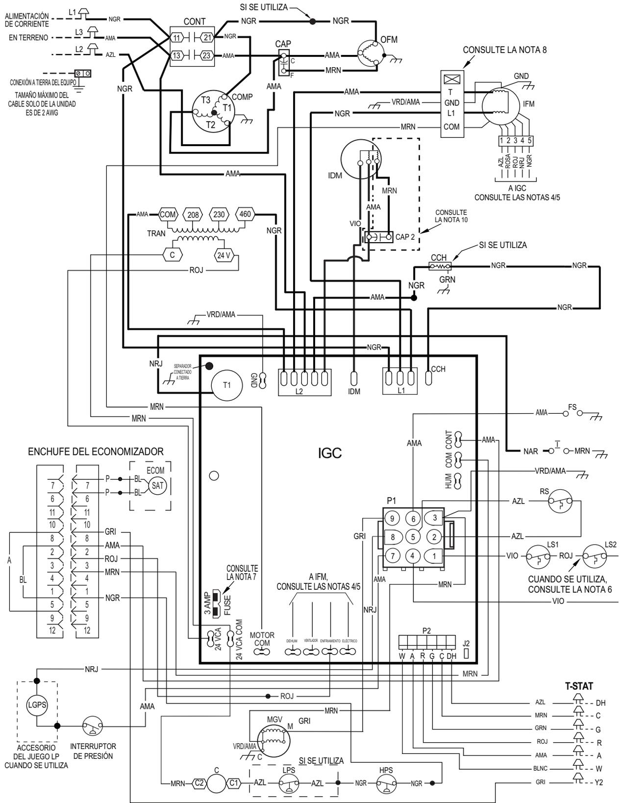
**Fig. 18 – Diagrama eléctrico de conexión 460-3-60**
