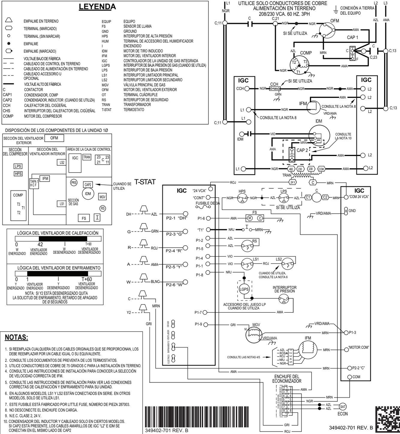
Fig. 19 – Diagrama eléctrico en escalera 460-3-60
