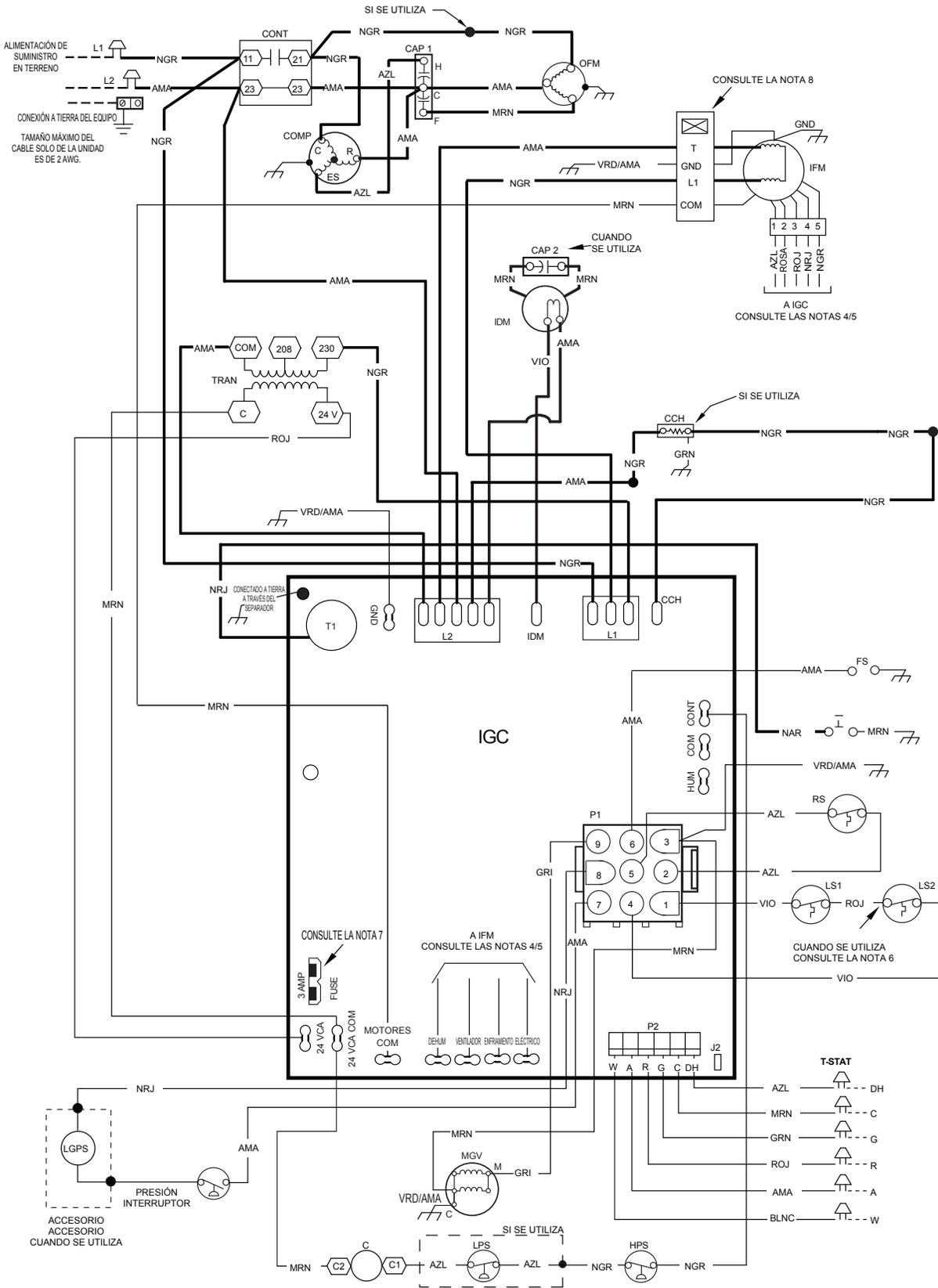
**Fig. 14 – Diagrama eléctrico de conexión 208/230-1-60**
