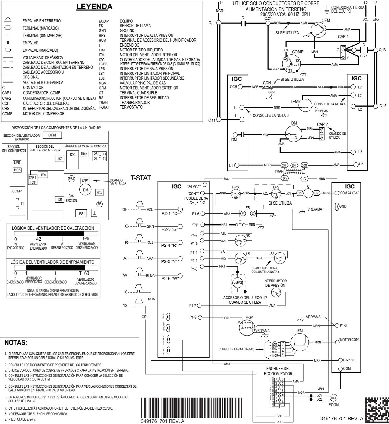
Fig. 17 – Diagrama eléctrico en escalera 208/230-3-60
