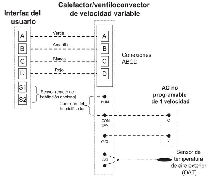
**Fig. 2 – Diagrama de conexión del calefactor o el ventilador FE con AA de una etapa**
