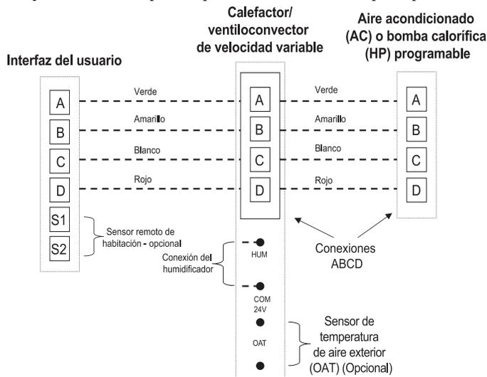
**Fig. 1 – Diagrama de conexión de cuatro cables**
