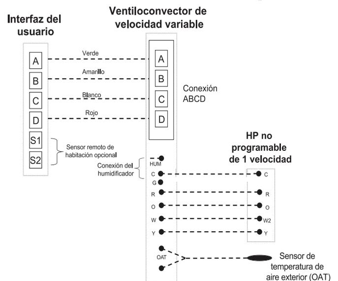
**Fig. 3 – Diagrama de conexión del ventilador FE con bomba de calor de una etapa sin comunicación**
