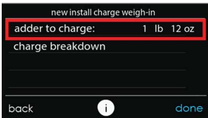
Fig. 20 – Carga adicional necesaria para la nueva instalación
