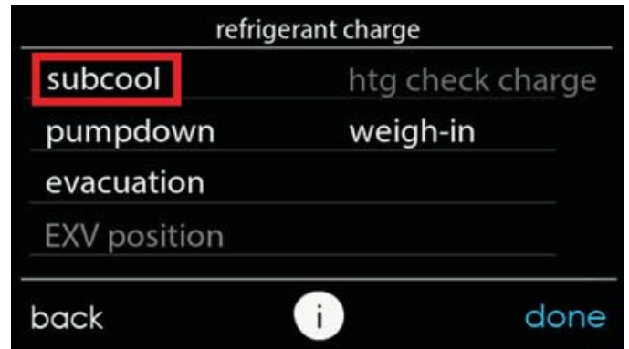
Fig. 13 – Seleccione "Subcooling" (Subenfriamiento) en Refrigerant (Refrigerante) A200031
