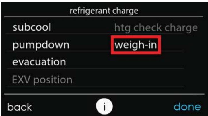
Fig. 16 – Opción de pesaje para carga inferior a 65 °F del OAT y superior a 105 °F del OAT A200034
