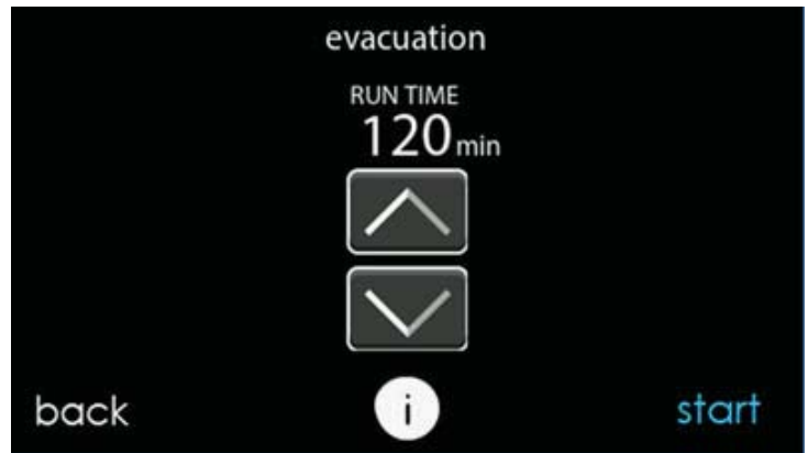
Fig. 24 – Pantalla de configuración de la evacuación A200042
