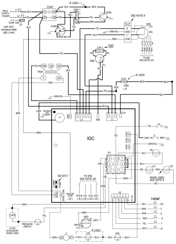
Fig. 14 – 208/230-1-60 Connection Wiring Diagram
