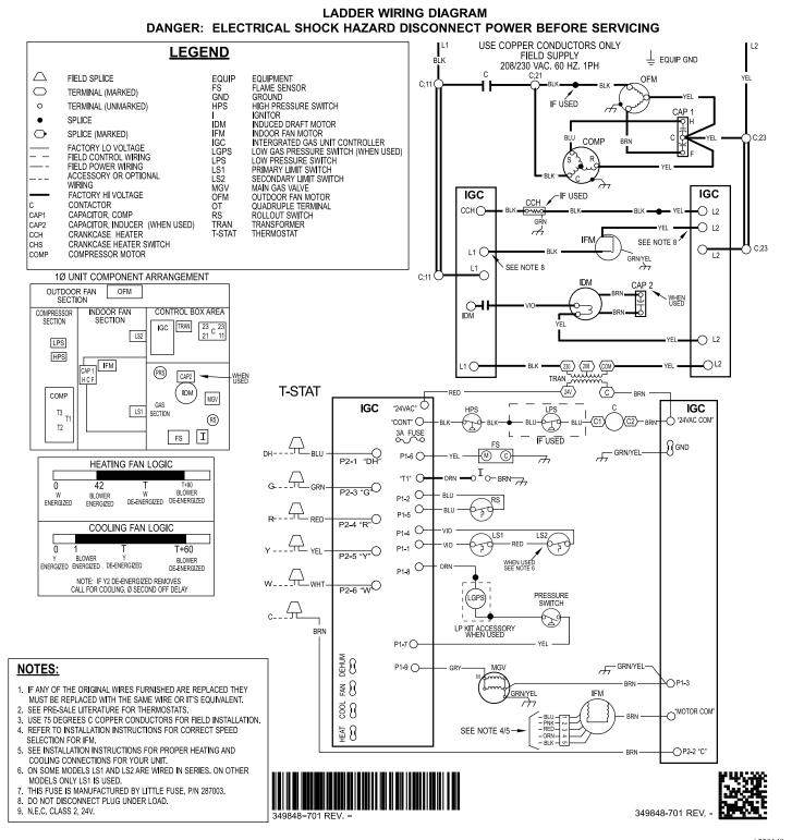
Fig. 15 – 208/230-1-60 Ladder Wiring Diagram
