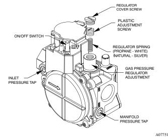
Fig. 13 – Single-Stage Gas Valve
