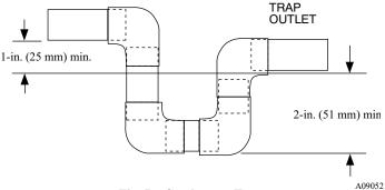
Fig. 7 – Condensate Trap
