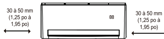
Fig. 13 – Suspension du module intérieur sur la plaque de montage
