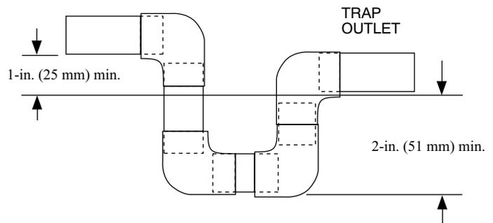
**Fig. 7 – Condensate Trap**
