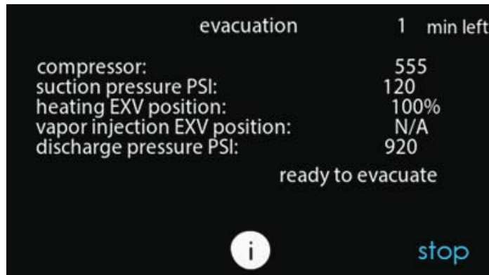
Fig. 24 – Pantalla de estado de la evacuación
