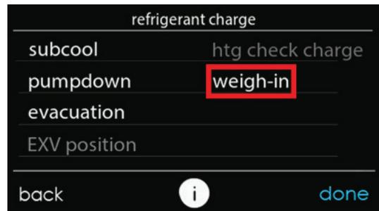
Fig. 15 – Option de pesée pour une charge à température ambiante extérieure inférieure à 18 °C (65 °F) ou supérieure à 41 °C (105 °F) A200034
