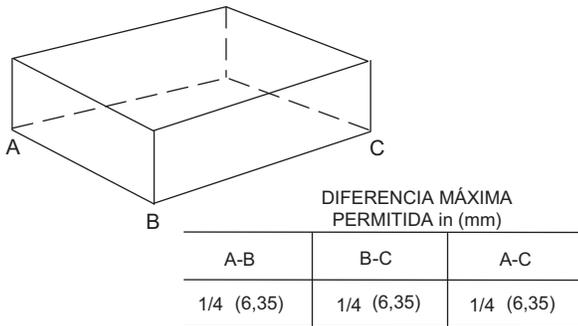
Fig. 6 – Tolerancias de nivelación de la unidad
