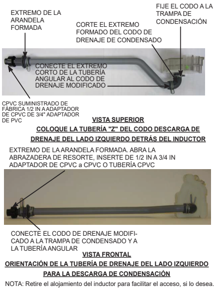
Fig. 16 – Conexión y enrutamiento de la trampa de drenaje (La apariencia puede variar)
