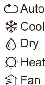
**Fig. 7 – Affichage du mode de fonctionnement**
