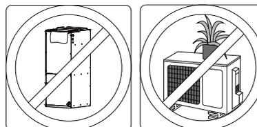
Fig. 18 – Ôtez tous les obstacles qui bloquent les entrées et sorties d'air
