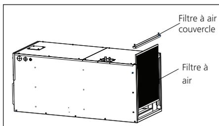
Fig. 10 – Retirez le couvercle du filtre à air
