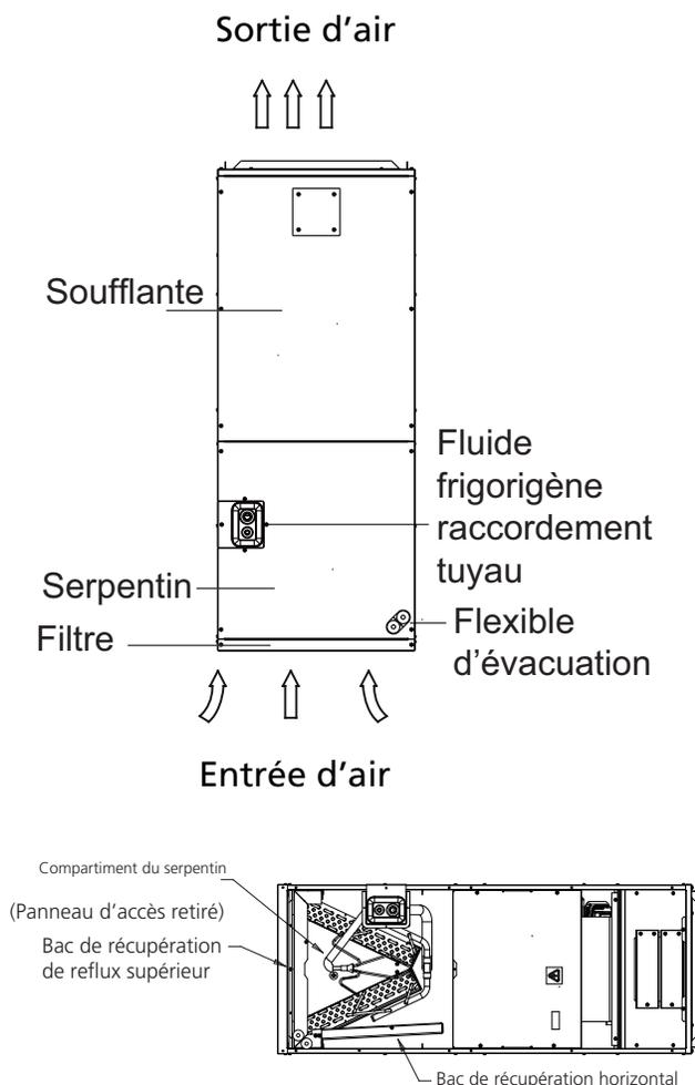
**Fig. 1 – Représentation de l'appareil intérieur**
