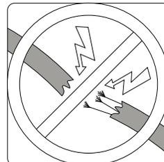
Fig. 15 – Vérifier si des câbles sont endommagés
