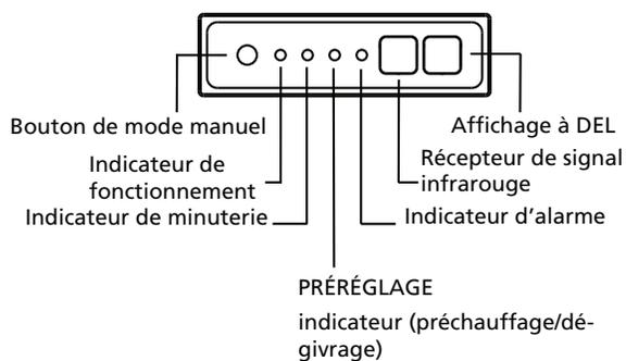
**Fig. 2 – Panneau d'affichage du récepteur infrarouge (IR)**
