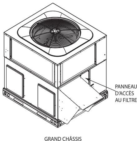
Figure 9 – Accès au filtre à grand châssis
