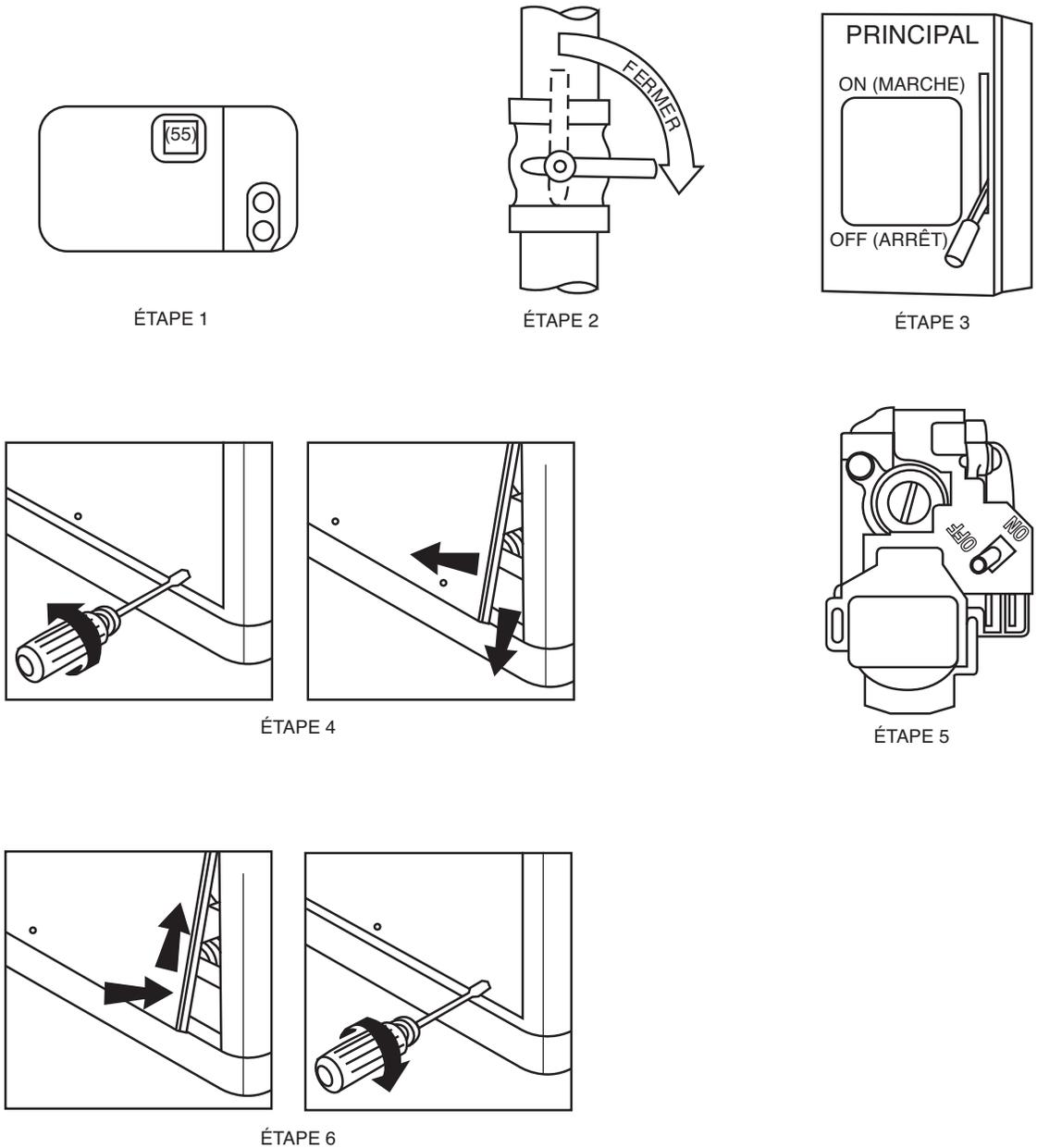
Figure 5 – Pour arrêter l'appareil de chauffage au gaz
