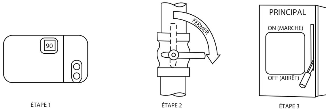
Figure 7 – Pour arrêter l'appareil de climatisation électrique
