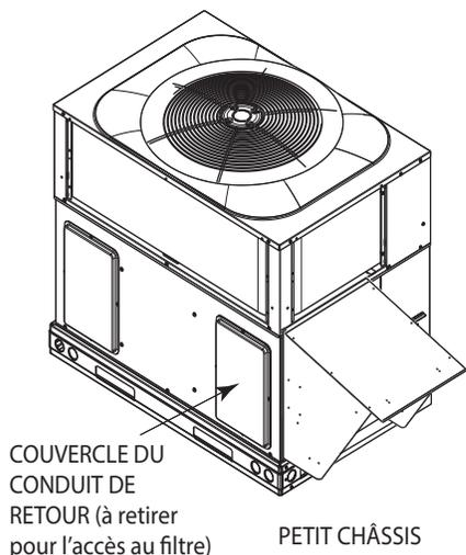
Figure 8 – Accès au filtre à petit châssis
