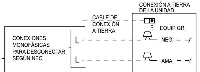
Fig. 12 – Conexiones de la línea eléctrica A10022 SP
