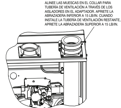
TUBERÍA DE VENTILACIÓN AL RAS MOSTRANDO EL ACOPLAMIENTO
