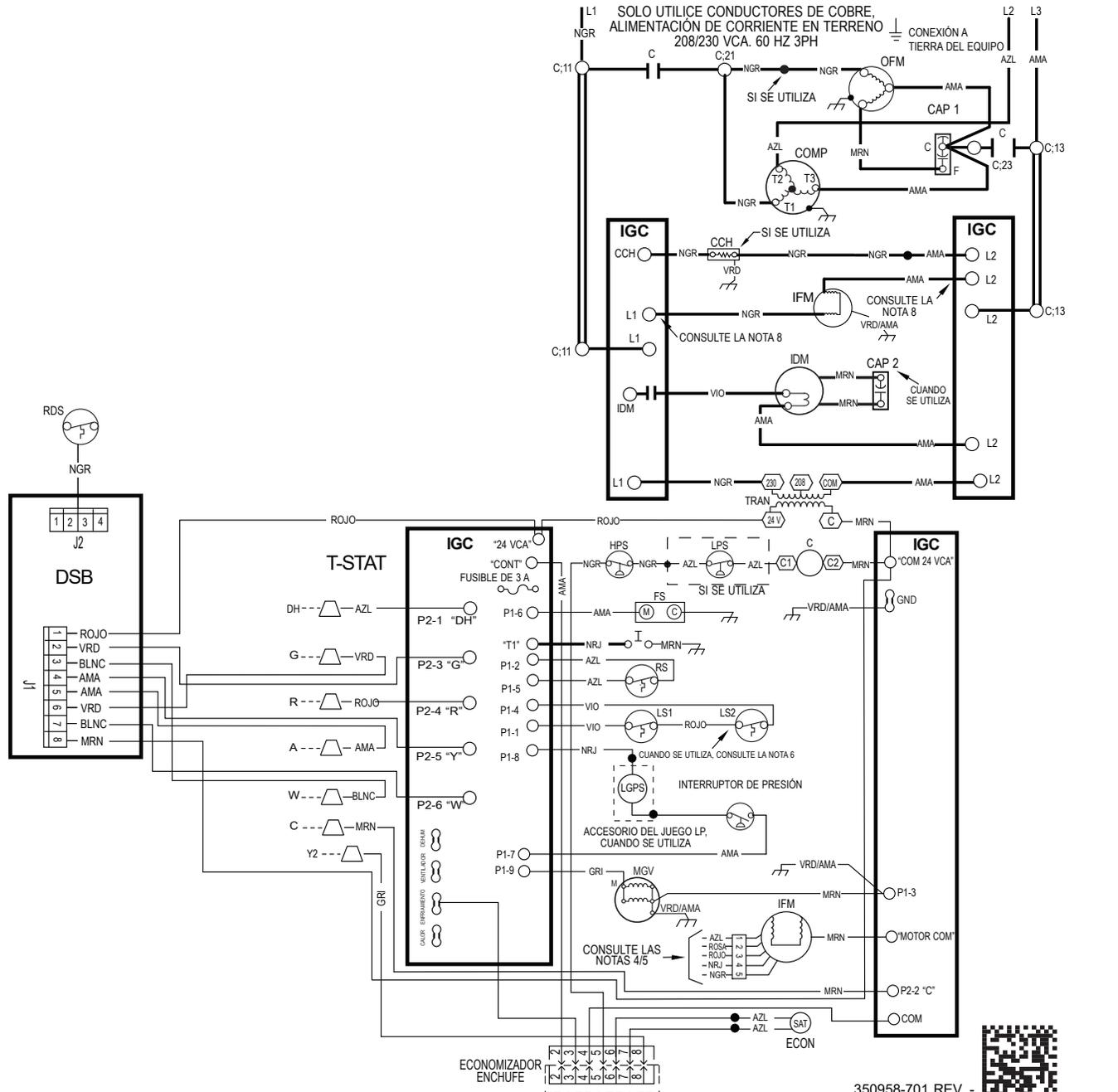
Fig. 20 – Diagrama eléctrico en escalera 208/230-3-60
