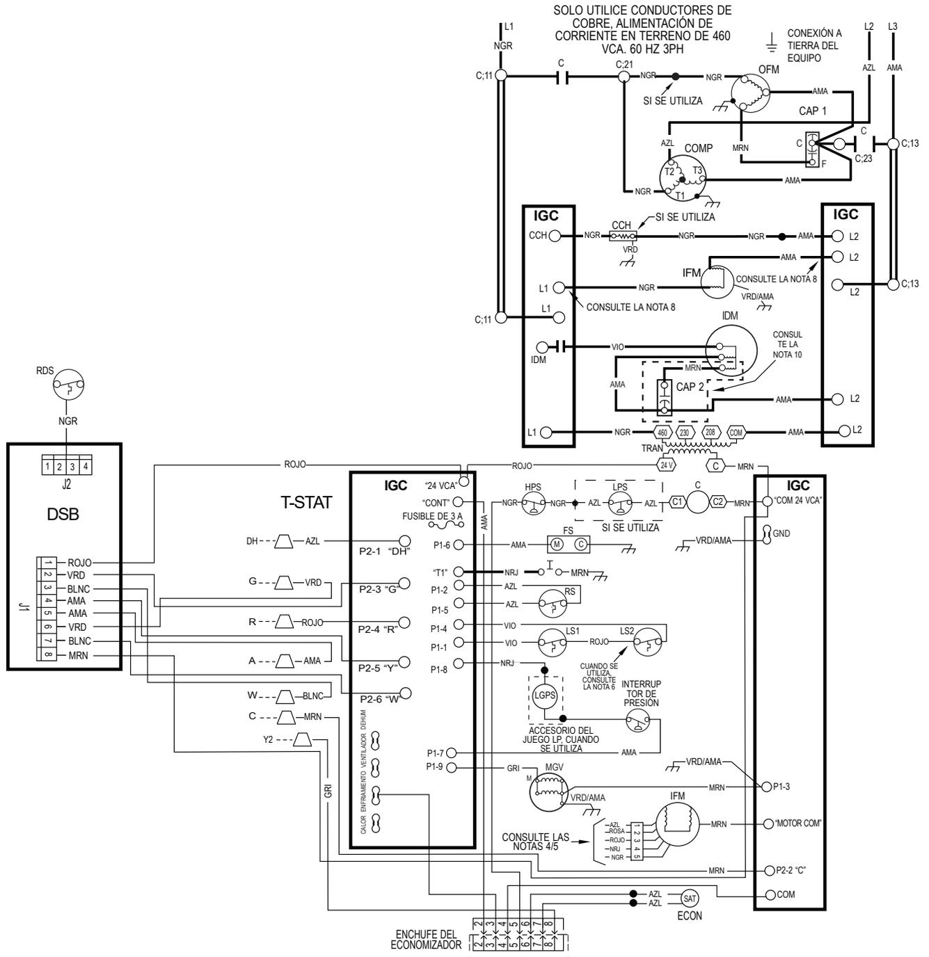
Fig. 22 – Diagrama eléctrico en escalera 460-3-60
