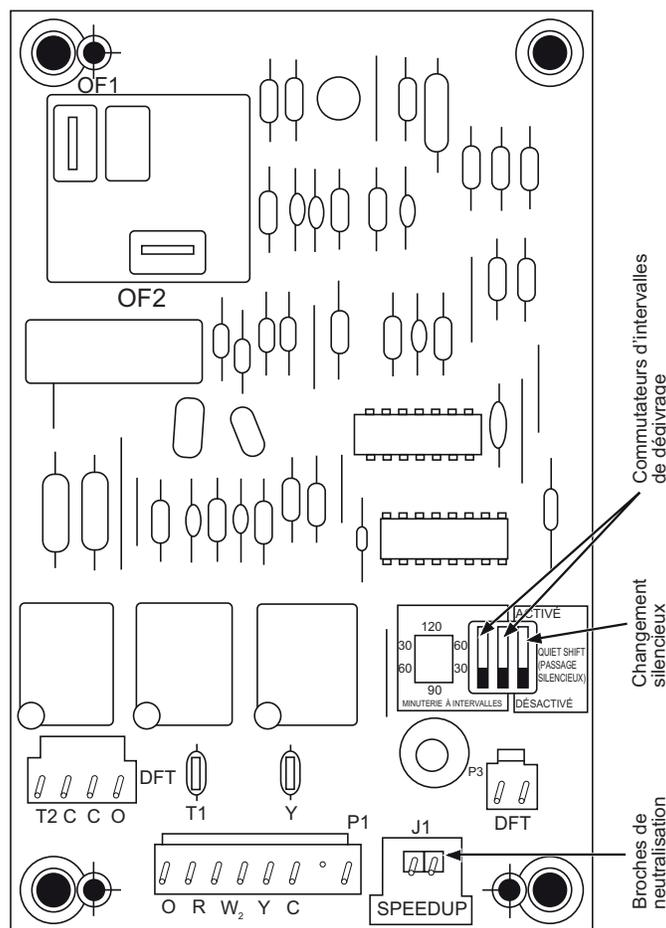
Fig.11 – Panneau de commande du Quiet Shift-2
