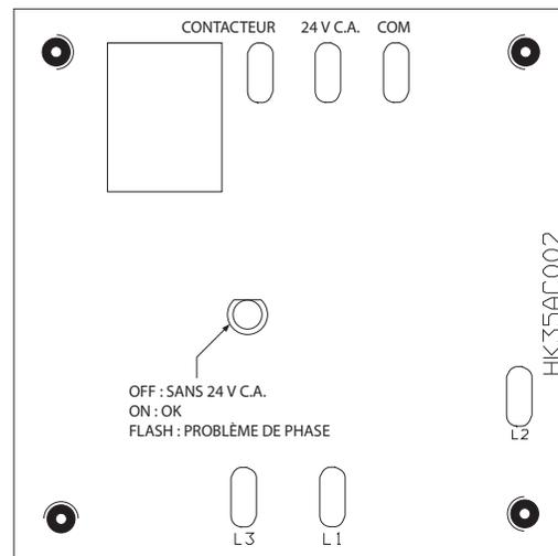
Fig. 9 – Panneau de moniteur pour appareils triphasés
