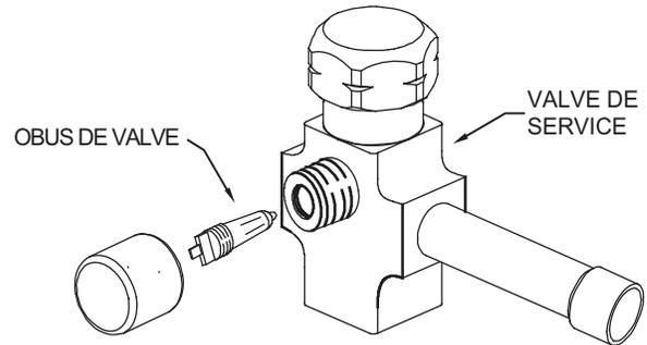
**Fig. 5 – Valve de service de vapeur**
