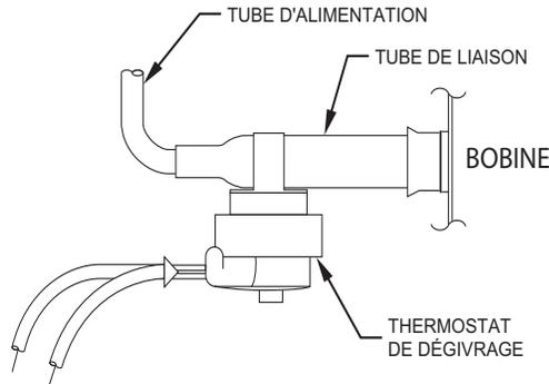
Fig. 3 – Emplacement du thermostat de dégivrage
