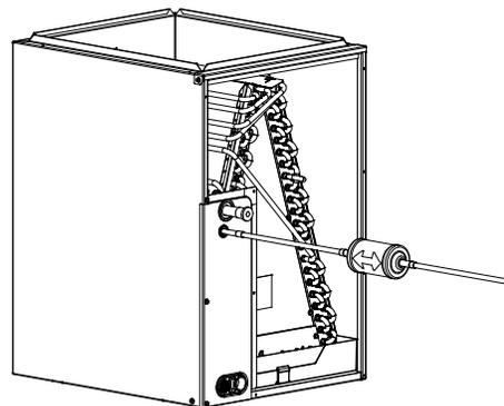
**Fig. 6 – Déshydrateur-filtre de la conduite de liquide**
