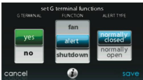
**Apagado:** esta opción de configuración permite seleccionar el cambio de estado necesario para el apagado. Seleccione **Normally Open** (Normalmente abierto) o **Normally Closed** (Normalmente cerrado) y, luego, guarde su selección.
