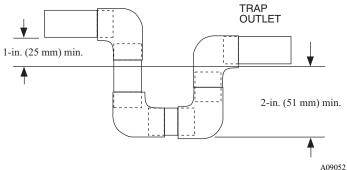
Fig. 7 – Condensate Trap
