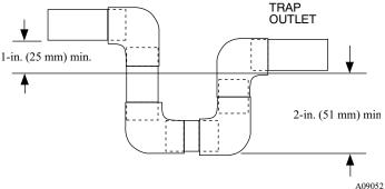
Fig. 7 – Condensate Trap
