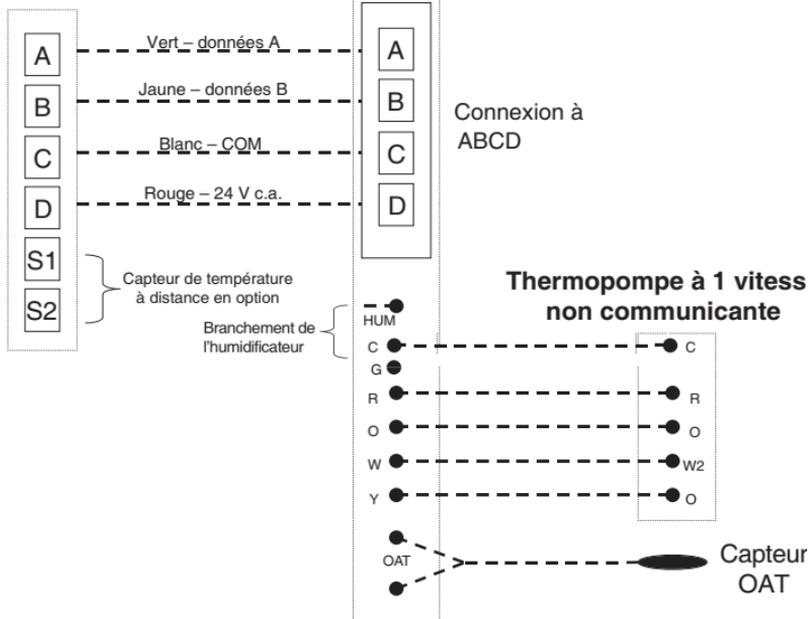
**Schéma de connexion pour ventilo-convecteur FE avec thermopompe à 1 phase sans communication**
