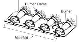
Fig. 65 – Burner Flame
