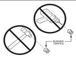
Fig. 63 – Orifice Hole
