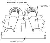
Fig. 65 – Burner Flame
