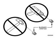
Fig. 63 - Orifice Hole
