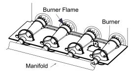
Fig. 65 - Burner Flame
