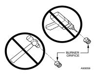
Fig. 63 – Orifice Hole
