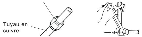
**Fig. 28 – Serrage de l'écrou évasé**
