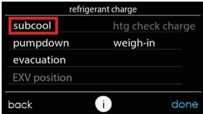
Fig. 13 – Seleccione "Subcooling" (Subenfriamiento) en Refrigerant (Refrigerante) <sup>A20031</sup>
