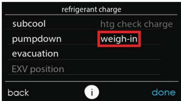
Fig. 16 – Opción de pesaje para carga inferior a 65 °F del OAT y superior a 105 °F del OAT <sup>A20034</sup>
