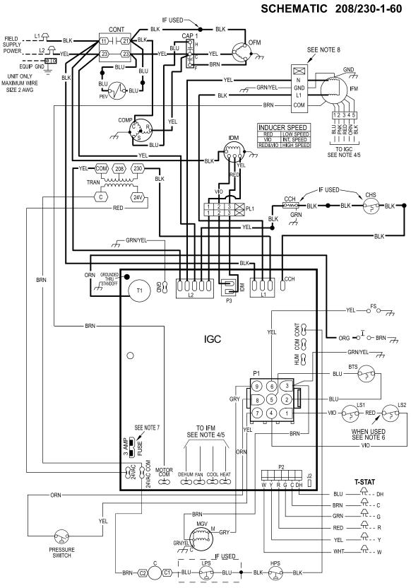
CONNECTION WIRING DIAGRAM DANGER: ELECTRICAL SHOCK HAZARD DISCONNECT POWER BEFORE SERVICING SCHEMATIC 208/230-1-60
