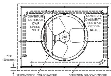
Fig. 2 – Détails du montage sur dalle
