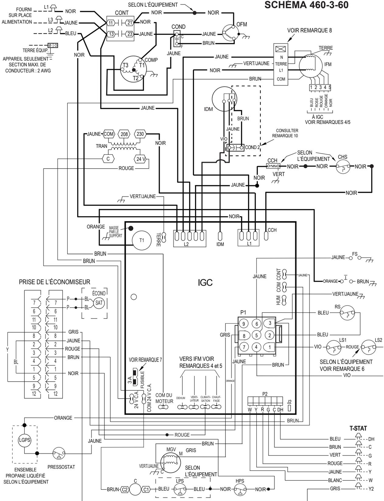
**Fig.18 – Schéma de connexion de câblage – 460-3-60**
