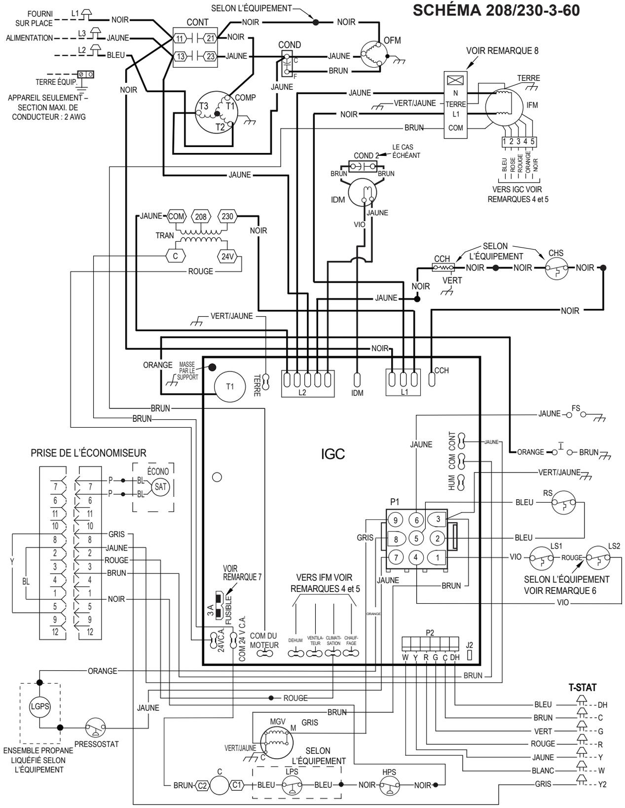
**Fig.16 – Schéma de connexion de câblage – 208/230-3-60**
