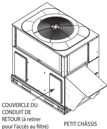
Figure 3 – Accès au filtre à petit châssis
