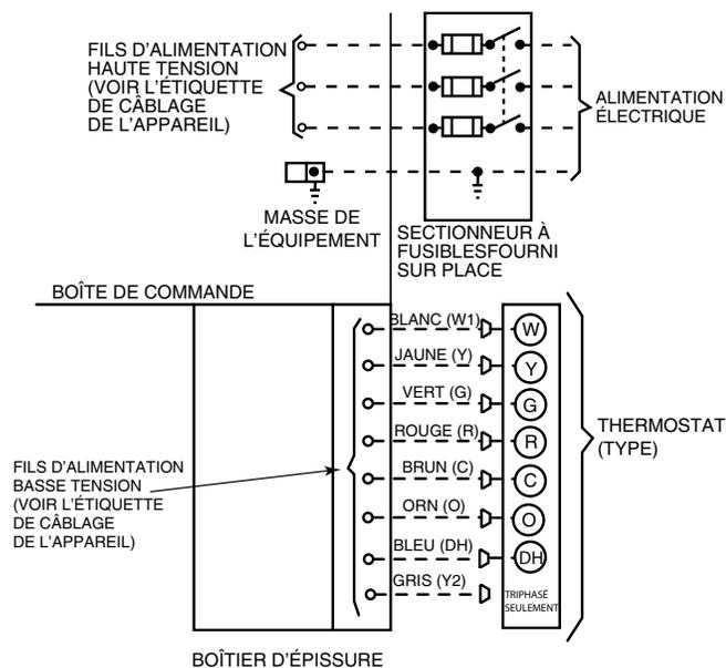
Fig. 9 – Branchements haute et basse tensions
