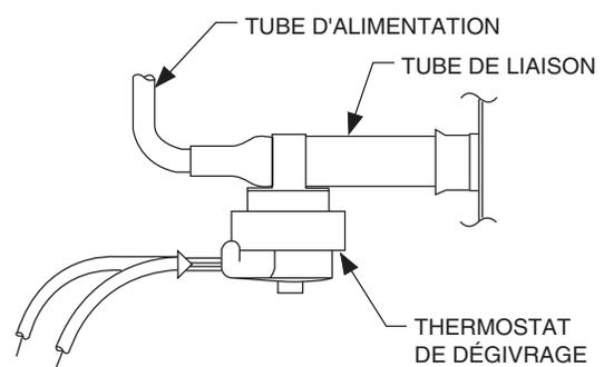
Fig. 21 – Emplacement du thermostat de dégivrage
