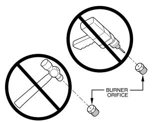
Fig. 61 – Orifice Hole
