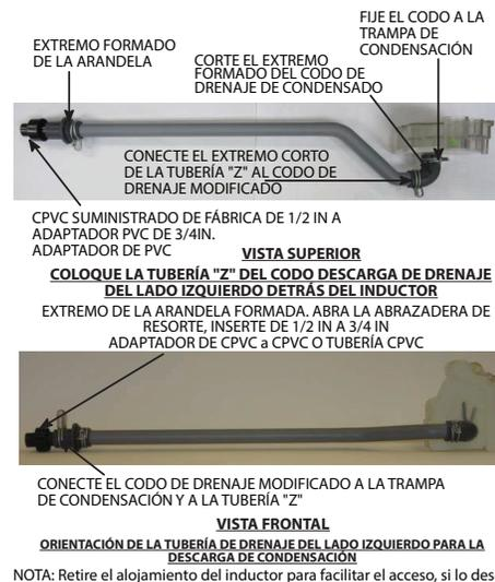
**Fig. 15 – Conexión y enrutamiento de la trampa de drenaje**
