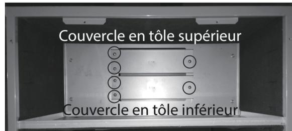
**Fig. 4 – Retirez les couvercles en tôle**
