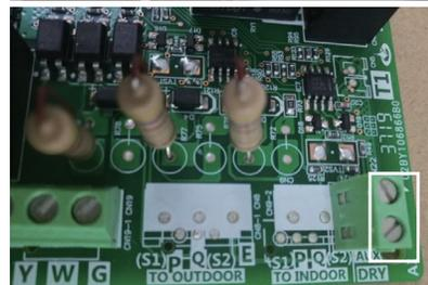
**Fig. 10 – Raccordez les fils du chauffage auxiliaire**
