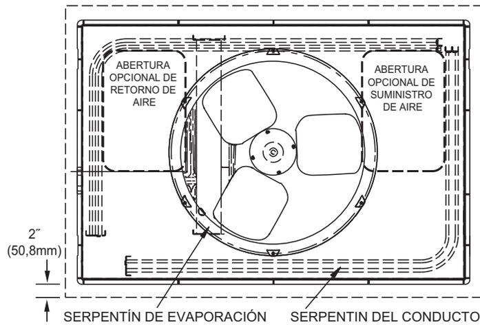
Fig. 2 – Detalles del montaje en bloque
