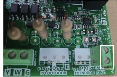
**Fig. 30 – Raccordez les fils du chauffage auxiliaire**
