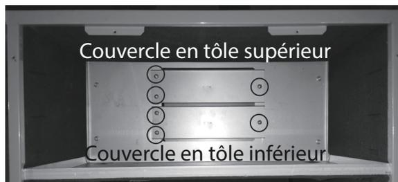
**Fig. 24 – Retirez les couvercles en tôle**
