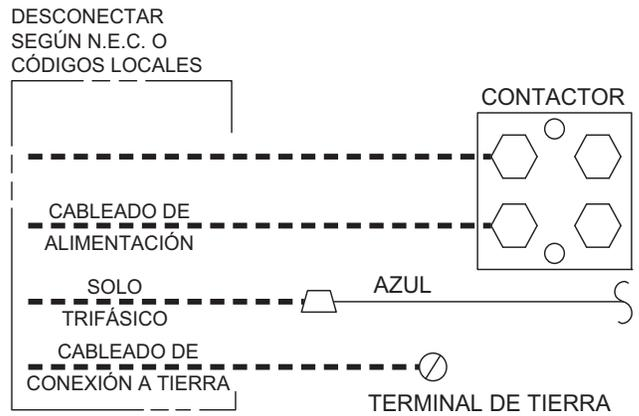
**Fig. 8 – Conexiones de línea**
