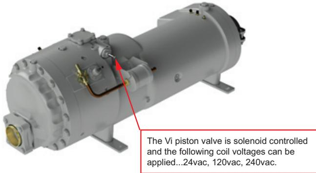
**Fig. 10 — Vi Piston Valve Location**
