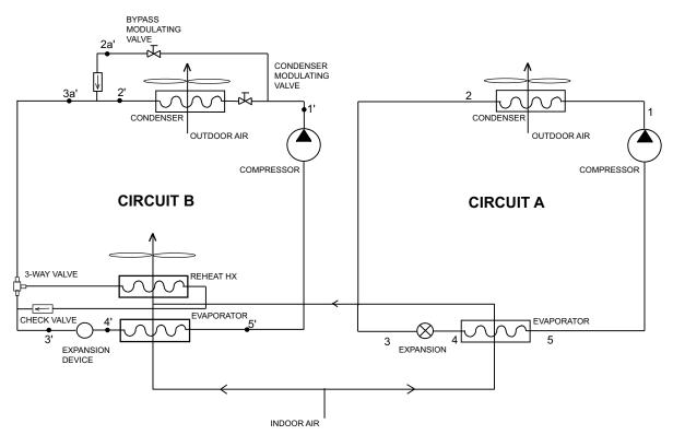
Fig. 15 — Humidi-MiZer System Diagram
