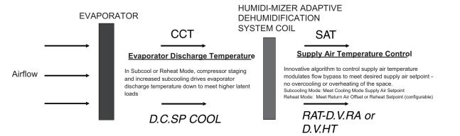
Fig. 14 — Humidi-MiZer® System Control
