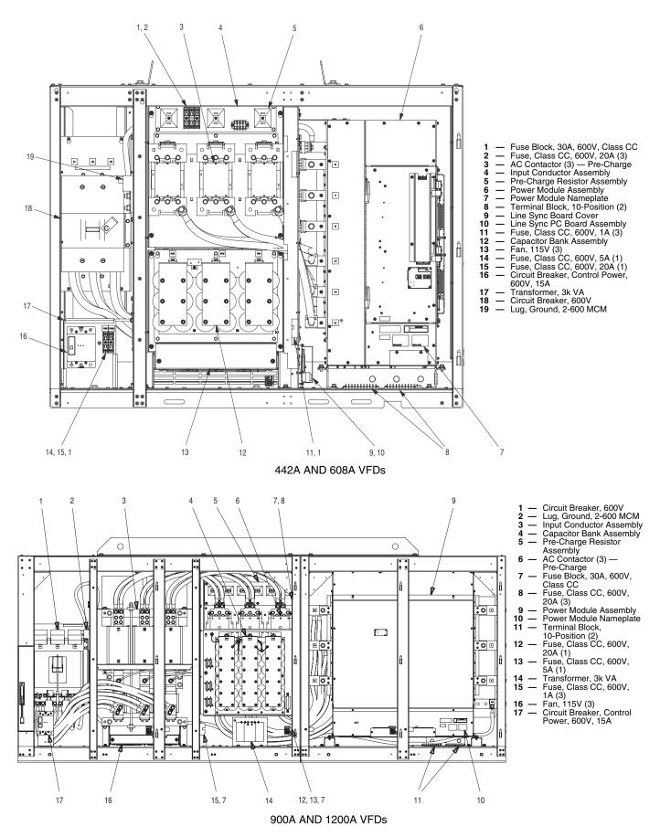
Fig. 10 — LiquiFlo<sup>™</sup> 2 Variable Frequency Drive (VFD) Internal
