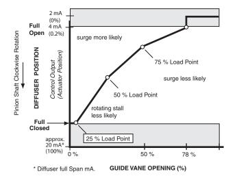
Fig. 26 — Diffuser Control
