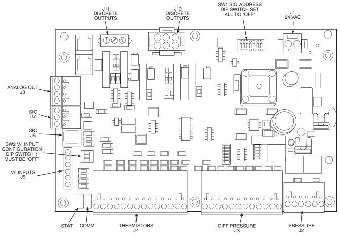
Fig. 56 — Chiller Control Module (CCM)
