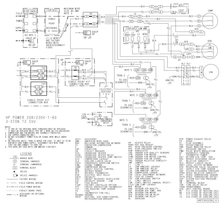
Fig. J — 50GCQ 04-06 SystemVu™ Power Wiring Diagram — 208/230-1-60
