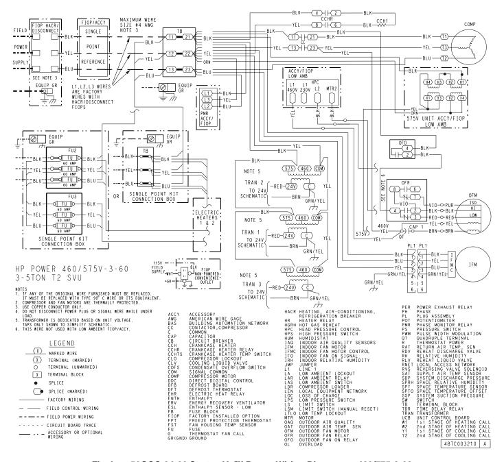
Fig. L — 50GCQ 04-06 SystemVu™ Power Wiring Diagram — 460/575-3-60
