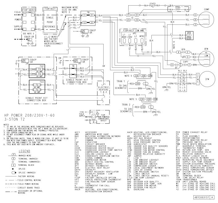
Fig. G — 50GCQ 04-06 Power Wiring Diagram — 208/230-1-60
