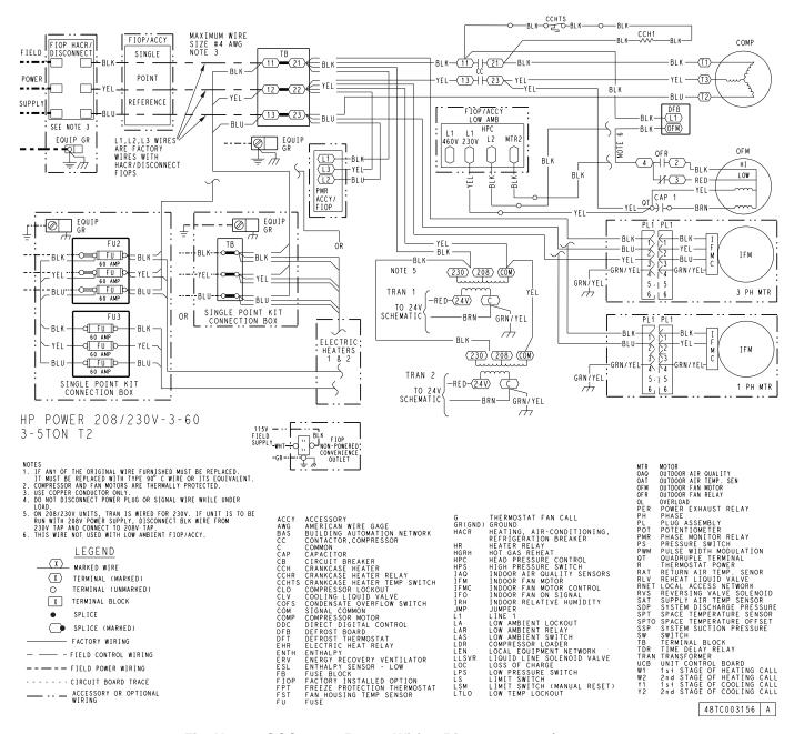
Fig. H — 50GCQ 04-06 Power Wiring Diagram — 208/230-3-60
