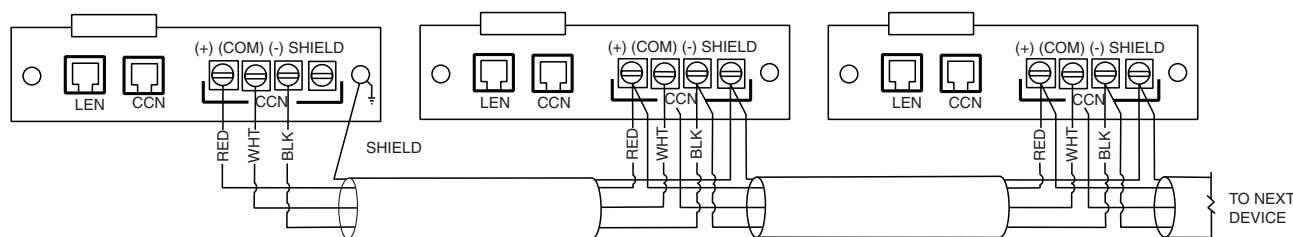
**Fig. 59 — TB3 — CCN Wiring**
