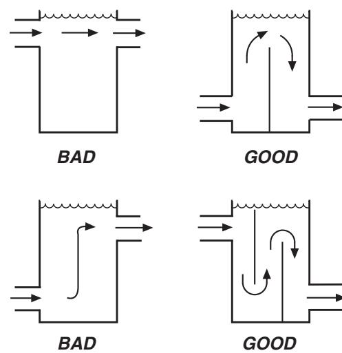
**Fig. 41 — Tank Baffling**
