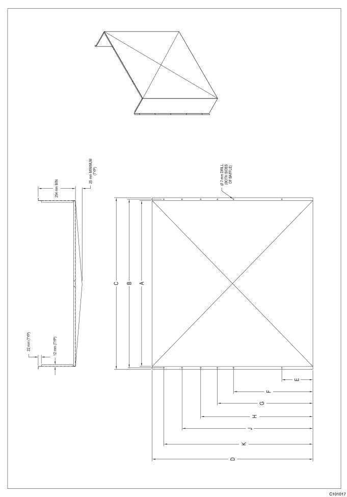
Fig. 39 - Wind Baffles
