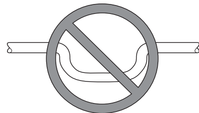
Fig. 17 – Siphon de condensat insuffisant
