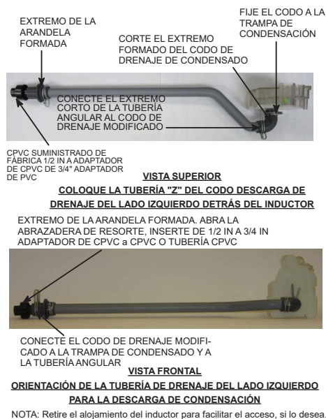
Fig. 16 – Conexión y enrutamiento de la trampa de drenaje (La apariencia puede variar)
