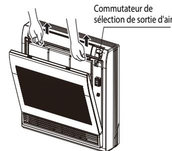
Fig. 28 – Retirez le filtre à air
