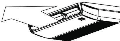
**Fig. 16 – Débit d'air de climatisation (capacités 18-58)**
