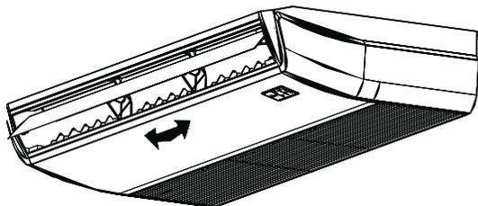
Fig. 22 – Volets droite-gauche (capacités 18-58)
