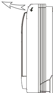
**Fig. 15 – Débit d'air de climatisation (capacité 12)**
